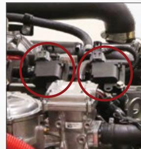
*Diseño de encendido con bobina sobre bujía*
