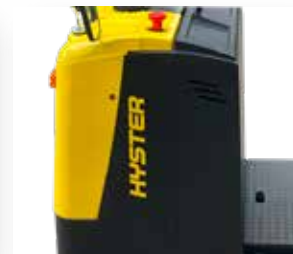
Acceso fácil para el servicio por medio de la cubierta frontal
