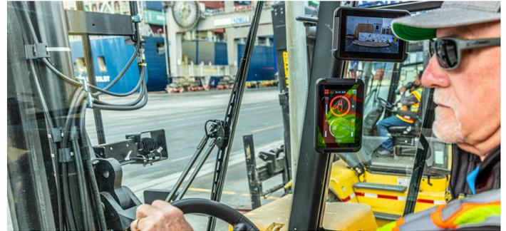
Neben diesen speziellen Designvorteilen spielen auch bei Elektrostaplern grundlegende ergonomische Elemente eine wichtige Rolle, z. B. die Sichtverhältnisse und die Fahrerposition. Ob nun Stapler mit Elektroantrieb oder Verbrennungsmotor, diese Merkmale weisen auf eine Ausstattung hin, die den Komfort und die Effizienz des Fahrers unterstützt:
