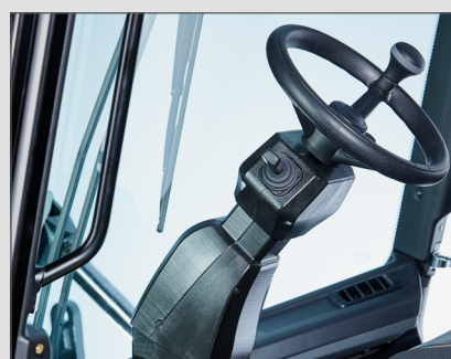
Colonne de direction entièrement réglable
