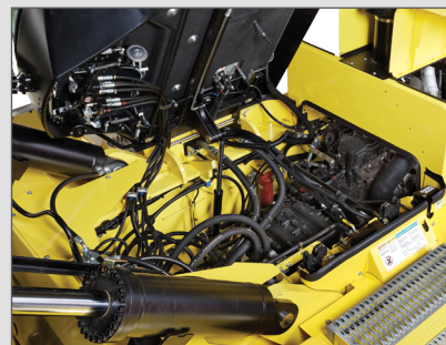
Circuit hydraulique à la demande
