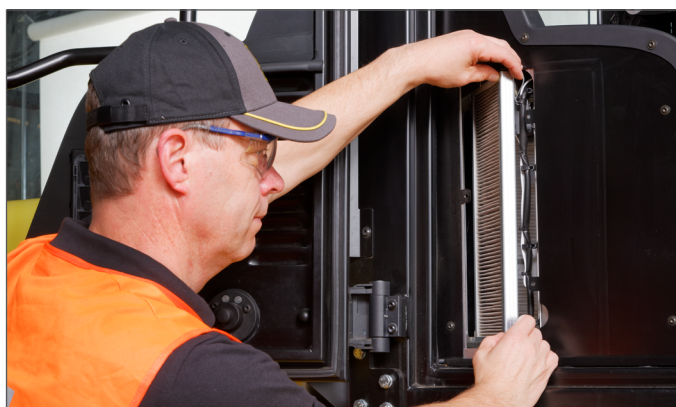
Filtre intérieur de la cabine facile d'accès
