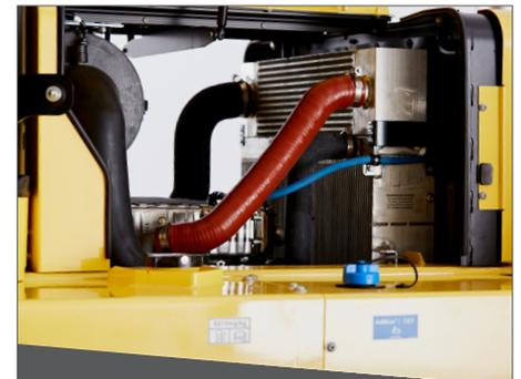
*Quad-Core-Konfiguration ermöglicht eine effiziente Kühlung. Gilt nur für Stufe-III-konforme Motoren.*
