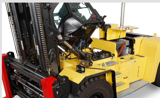
L'inclinazione elettrica opzionale della cabina consente un facile accesso ai principali componenti idraulici
