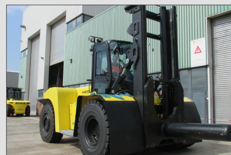
Traslazione laterale a piastra con posizionamento idraulico delle singole forche
