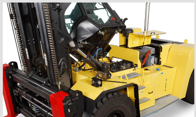
De optionele elektrische cabinekanteling biedt eenvoudige toegang tot de belangrijkste hydraulische componenten
