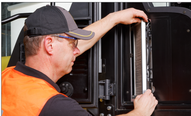
Gemakkelijk toegankelijk interieurfilter
