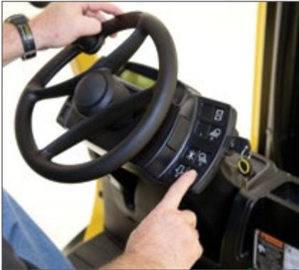
Columna de la dirección infinitamente ajustable
